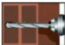
2. Limpie el orificio, sople 2 veces con ayuda de una bomba de aire. Limpie 2 veces el orificio, utilizando una escobilla de nylon.
